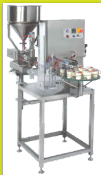
Conditionneuse automatique (débit 1 000 pots/heure avec 1 seule personne).
