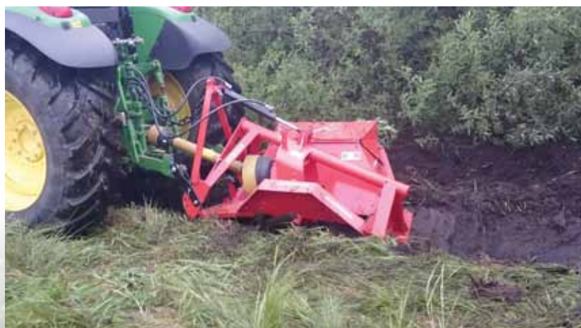
▲ Tracteur en zone humide équipé d'une rigoleuse.
